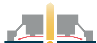
LED oberhalb der Leiterplatte
