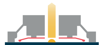
LED unterhalb der Leiterplatte
